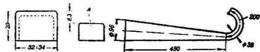
Рис. 23. Размеры выпускного окна двигателя 123 см 3 :
