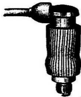
Рис. 72. Предохранение свечи резиновой трубкой
