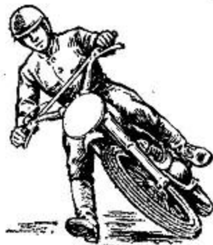
Рис. 24. Положение мотоциклиста на повороте при поддержке мотоцикла ногами
