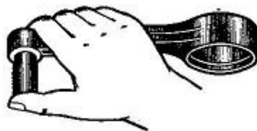
Рис. 41. Проверка прохождения поршневого пальца во втулке
