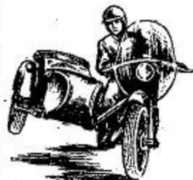
Рис. 20. Положение коляски мотоцикла при резком правом повороте
