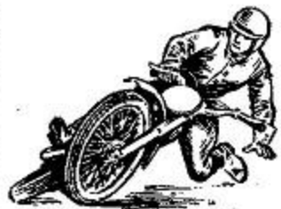
Рис. 25. Положение мотоциклиста в момент падения при заносе заднего колеса
