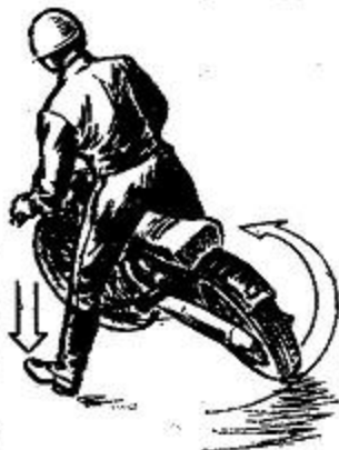
Рис. 10. Поворот на мотоцикле на 180 и 360°
