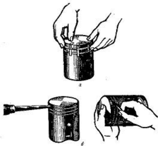
Рис. 38. а — снятие поршневых колец; б — удаление нагара с помощью шабера и конца сломанного кольца
